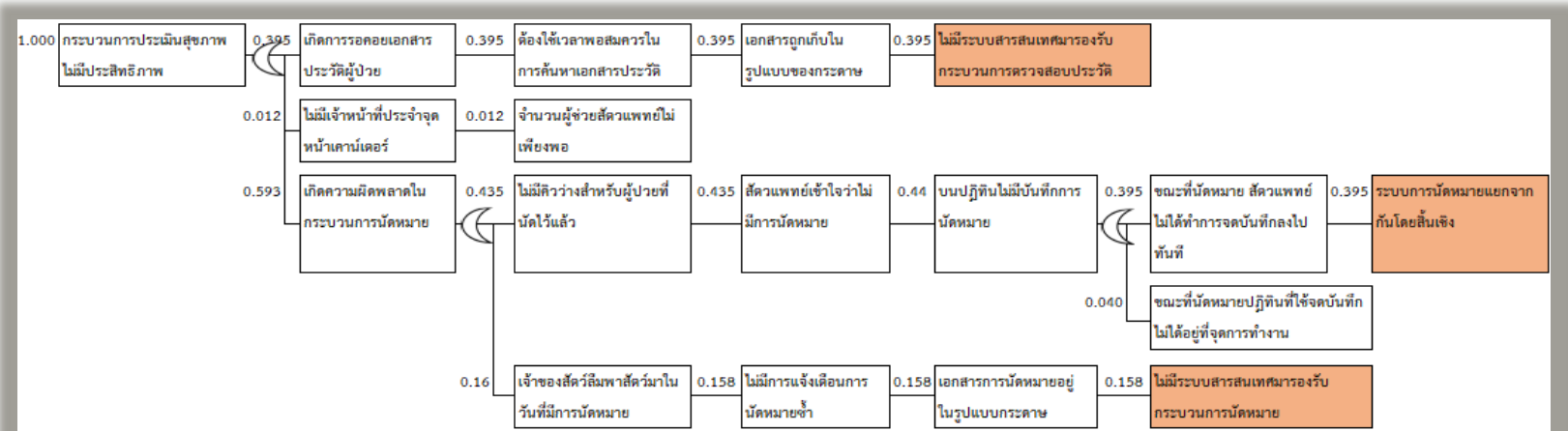
ภาพ 2 การวิเคราะห์ความผิดพลาดแบบแผนภูมิต้นไม้ (Fault Tree Analysis) ของโรงพยาบาลเ็นตุรึกษาสัตว์
