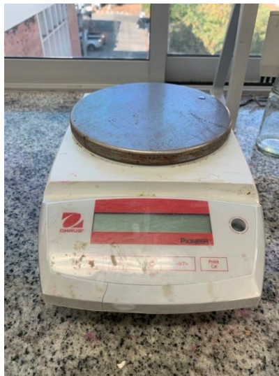
ภาพ 3.12 เครื่องชั่งน้ำหนักความละเอียด 0.01 กรัม
