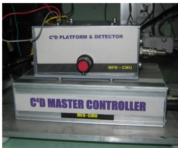
ภาพ 2.9 ระบบ C4D ต่อเข้ากับอุปกรณ์ตรวจวัด
