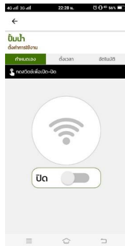
ภาพ 3.9 การสั่งเปิด ปิดปั้มน้ำด้วยตนเอง
