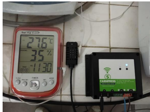
ภาพ 3.18 เทียบกับเทอร์โมมิเตอร์ ภาพ 3.19 เทียบกับเครื่อง Digital Hygro - Thermometer
