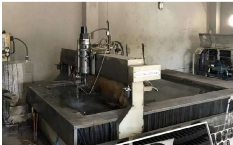
ภาพ 3.23 ตัดแผ่นเหล็กกล้าไร้สนิมด้วยเครื่อง Waterjet
