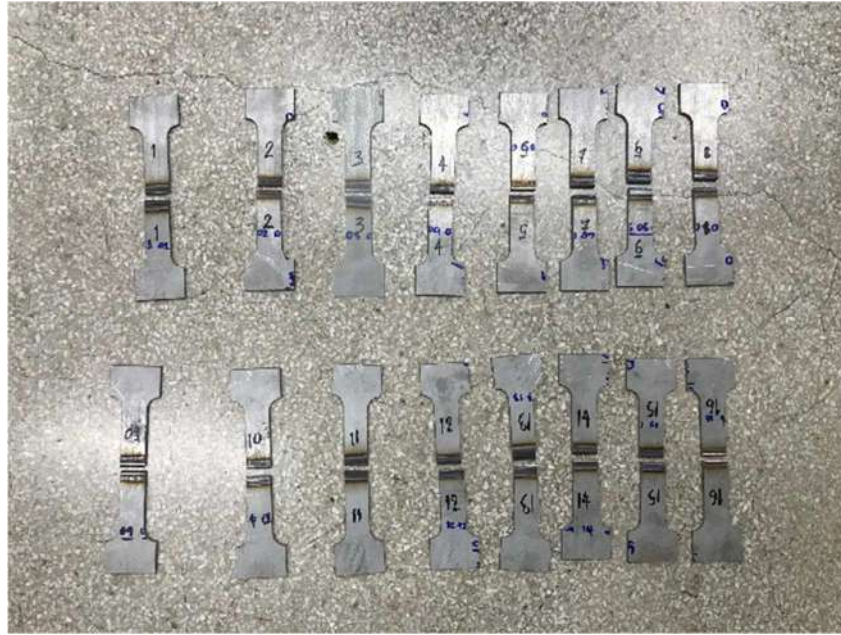
ภาพ 4.14 ชิ้นทดสอบที่ผ่านการทดสอบแรงดึง
