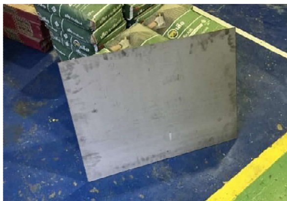
ภาพ 3.21 แผ่นเหล็กกล้าไร้สนิมขนาด 600X800X3 มิลลิเมตร
