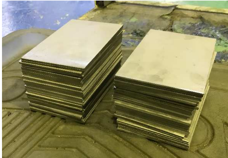
ภาพ 3.22 แผ่นเหล็กกล้าไร้สนิมขนาด 100X150X3 มิลลิเมตร
