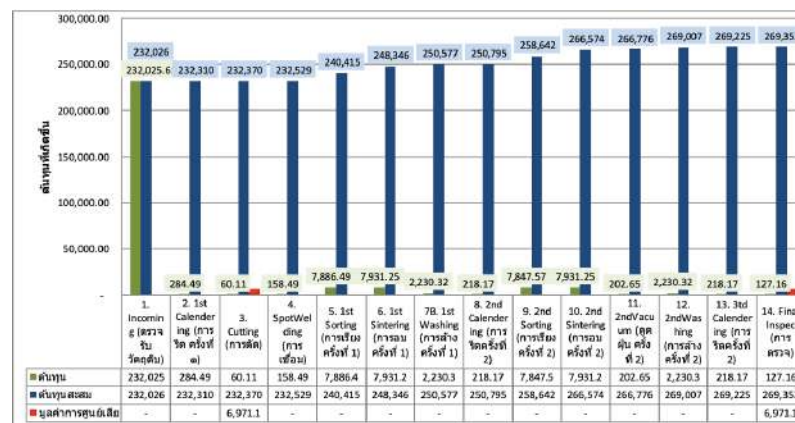
ภาพ 5.19 ตัวอย่างผลการวิเคราะห์ต้นทุนของระบบการรายงานคุณภาพแผนก Sintering
