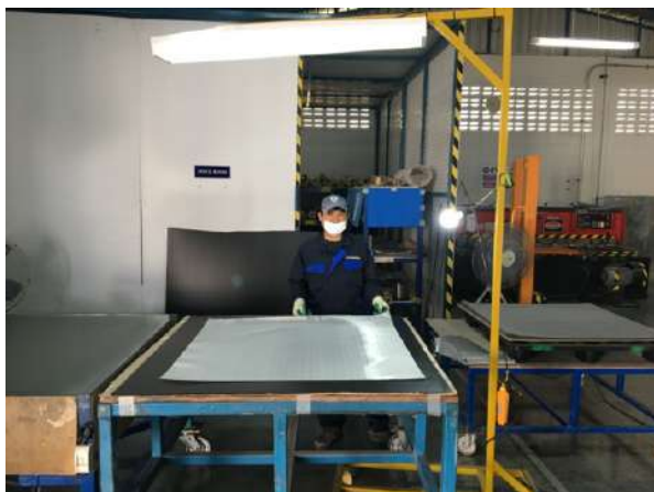
ภาพ 5.21 การปรับปรุงแสงสว่างพื้นที่ทำงานของกระบวนการตัด
