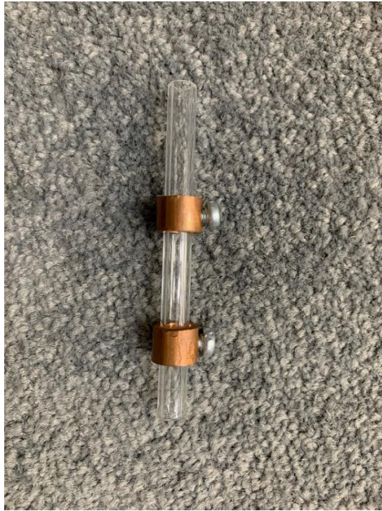
ภาพ 4.3 ลักษณะทองแดงที่ใช้เป็นขั้วอิเล็กโทรด
