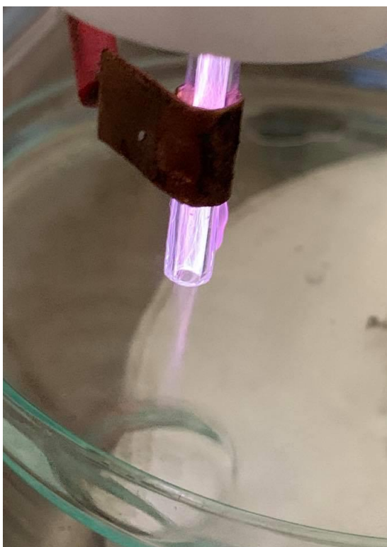
ภาพ 4.30 ทำการดิสชาร์จลงบนน้ำตาลฟรุคโตสไซรัป
