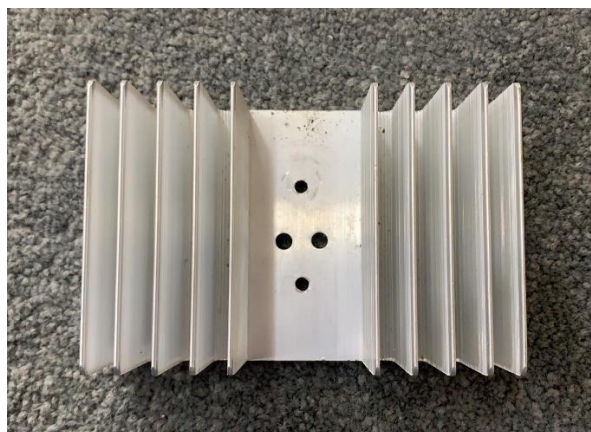
ภาพ 4.11 ซึ่งระบายความร้อนของ Mosfet IRF630A ที่ได้ทำการเปลี่ยน
