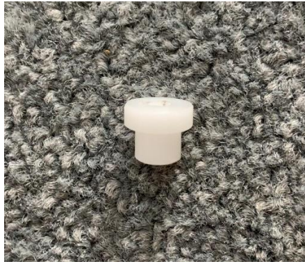
ภาพ 4.23 ข้อต่อลมที่ทำจากซูเปอร์ลีน
