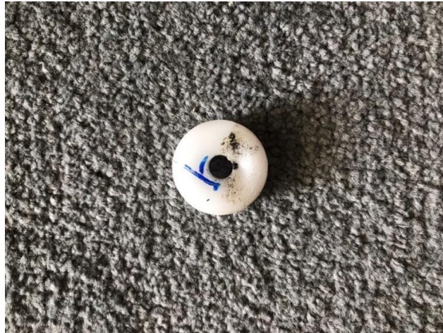
ภาพ 4.15 ฉนวนที่ทำจากซูเปอร์ลีนที่เกิดการเผาไหม้
