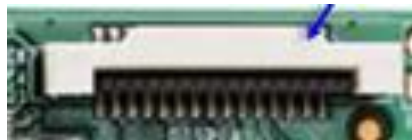
ภาพ 2.7 จุดต่อกล้องแบบ Camera Serial interface (CSI)
