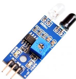
ภาพ 3.8 เซ็นเซอร์ตรวจจับวัตถุสิ่งกีดขวางแบบอินฟราเรด (Infrared IR Obstacle Avoidance Sensor)
