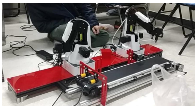
ภาพ 3.27 การประกอบแผ่นอะคริลิกเข้ากับอลูมิเนียมโปรไฟล์
