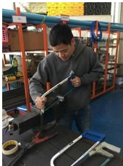
ภาพ 3.22 การตัดอลูมิเนียมโปรไฟล์
