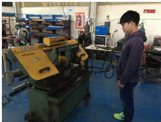
ภาพ 3.21 การตัดอลูมิเนียมโปรไฟล์ด้วยเครื่องตัดโลหะ
