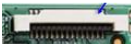
ภาพ 2.11 พอร์ต Display Serial Interface (DSI)
