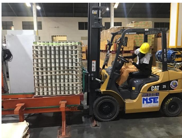
ภาพ 5.1 ป้อนพาเลตสู่เครื่องจักรสำหรับดูดลงสายพาน
