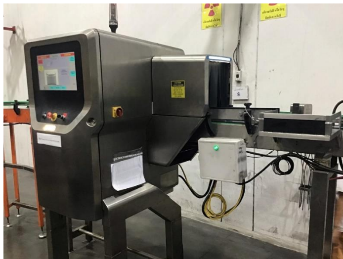
ภาพ 5.5 เครื่องตรวจสอบโลหะแปลกปลอมในผลิตภัณฑ์
