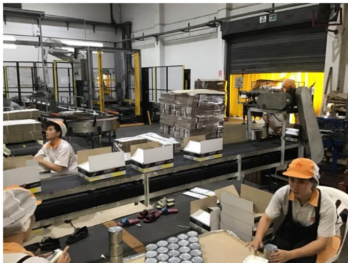
ภาพ 5.12 กล่องสินค้าถูกลำเลียงไปยังสถานีงาน ปิดผนึกกล่องสินค้า
