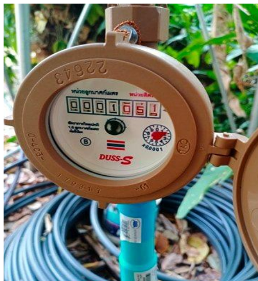
ภาพ ข-2 การเก็บข้อมูลจากมิเตอร์วัดน้ำ
