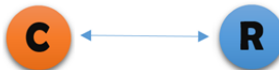
ภาพ 3.14 เครือข่ายแบบ Point to Point
