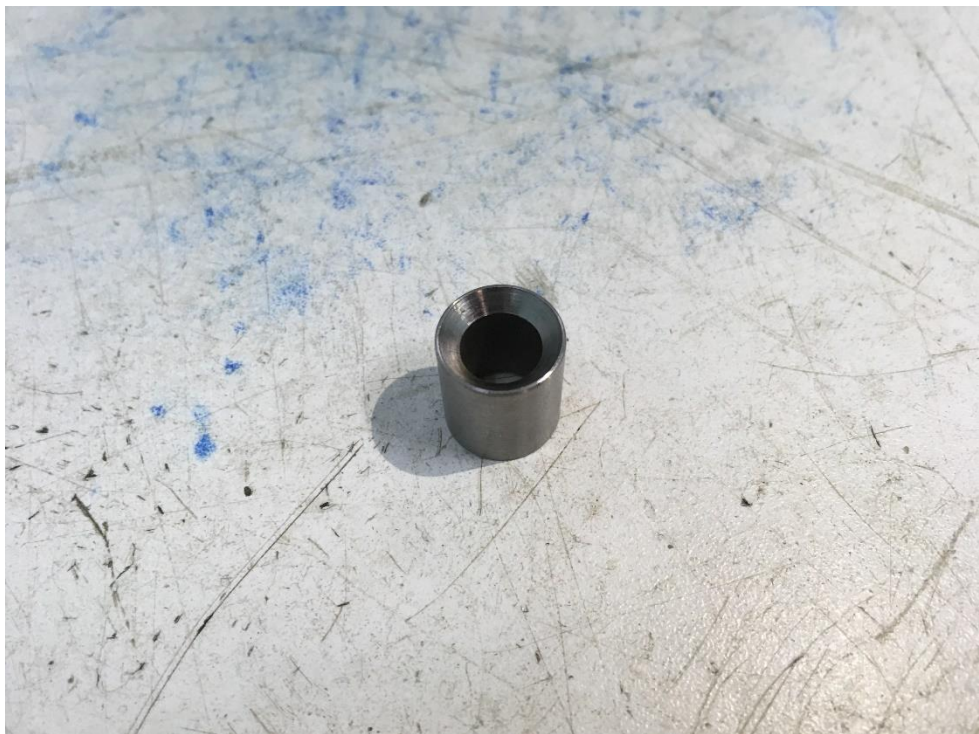
ภาพ ก-2 ลักษณะของเสียที่การลอบคมปากรูสึกเกินไป
