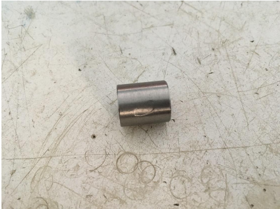
ภาพ ก-5 ลักษณะของเสี้ยนที่ผิวด้านข้างมีรอยตำหนิ
