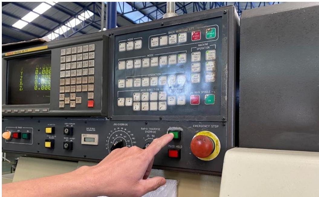
ภาพ 4.37 กดปุ่ม START เพื่อเริ่มต้นทำการผลิตชิ้นงาน
