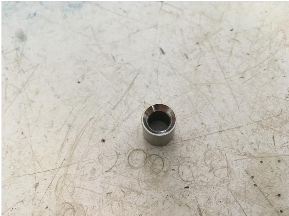
ภาพ ก-4 ลักษณะของเสียที่ผิวของมุมตัดไม่เรียบ
