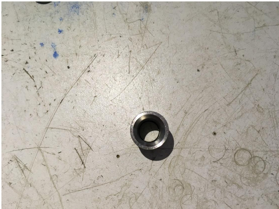
ภาพ ก-6 ลักษณะของเสี้ยนที่ครึ่งเป็นออกด้านใน
