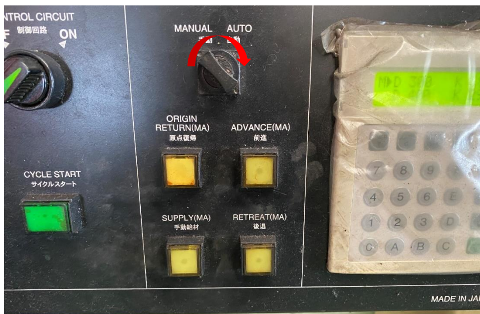
ภาพ 4.34 ปรับระบบรางเลื่อนจาก Manual ไปเป็น Auto
