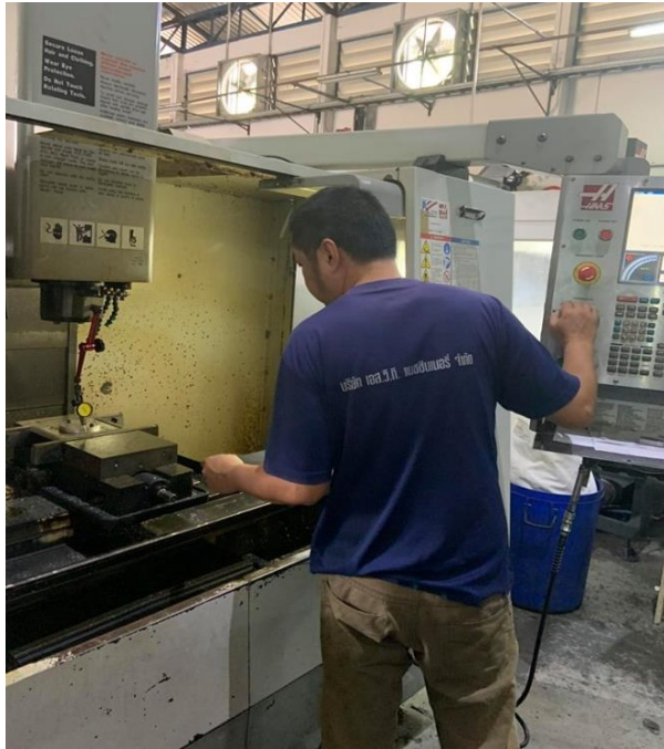
ภาพ 5.33 พนักงานเช็ค Stopper ด้วยการใช้เครื่องมือ Dial Gauge
