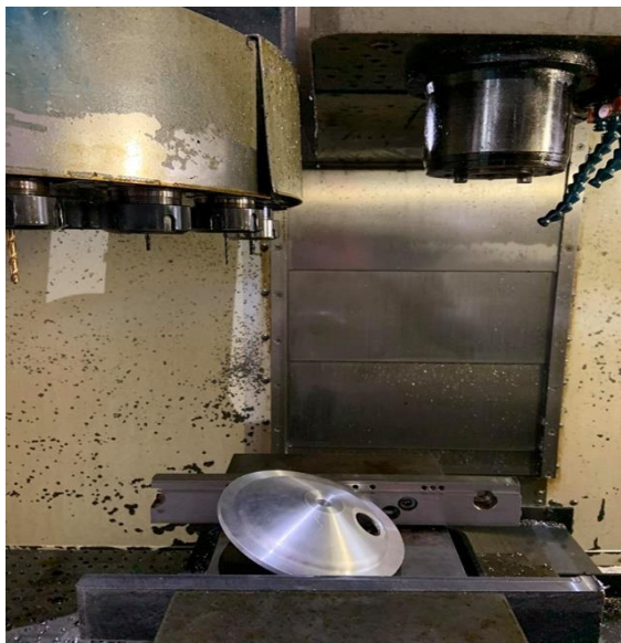
ภาพ 5.11 ลักษณะการวางชิ้นงานไม่ได้ตำแหน่ง
