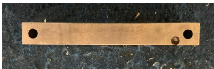
ภาพ 5.36 ลักษณะของเสียที่เกิดจากพนักงานเซตดอกกัดไม่ตรงกับจุดศูนย์กลางของรูเจาะ
