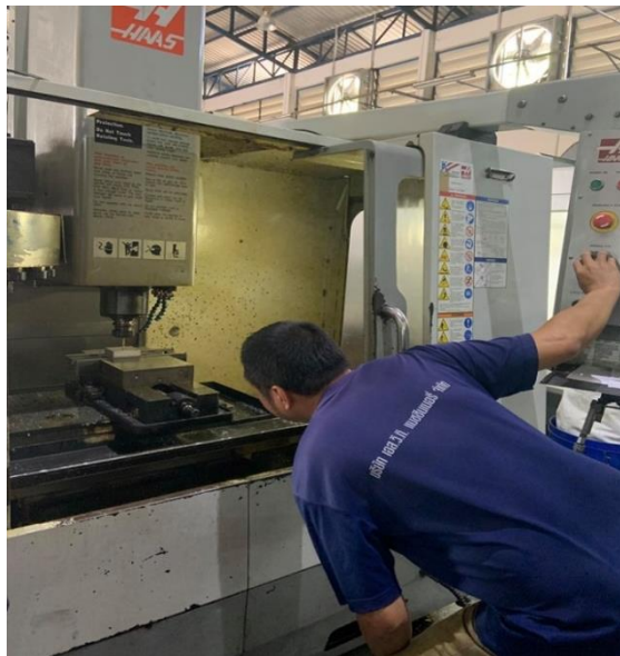
ภาพ 5.37 พนักงานตรวจสอบตำแหน่งดอกกัดกับจุดศูนย์กลางของรูเจาะด้วยการหมุนแกน Z ตะกับตำแหน่งจุดศูนย์กลางของรูเจาะ
