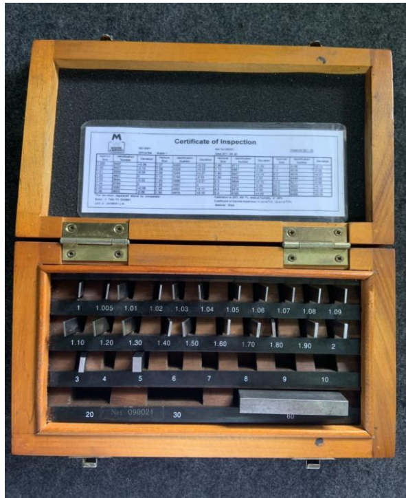
ภาพ 5.42 เกจบล็อกที่ใช้สอบเทียบเครื่องมือวัด
