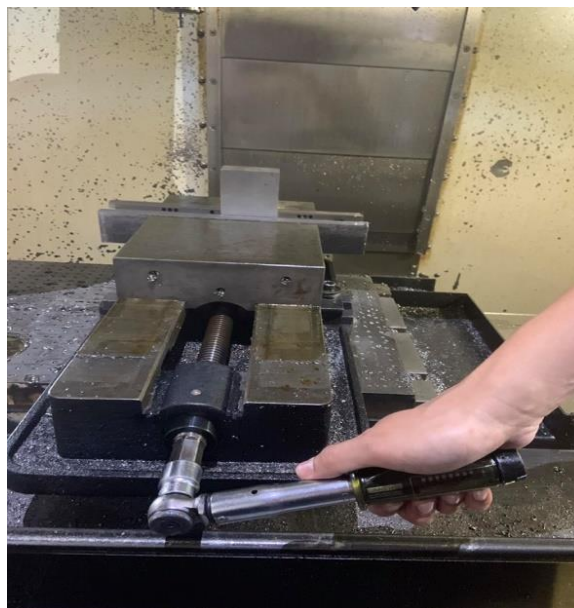
ภาพ 5.25 พนักงานใช้ประแจปอนด์ช่วยในการติดตั้งชิ้นงาน
