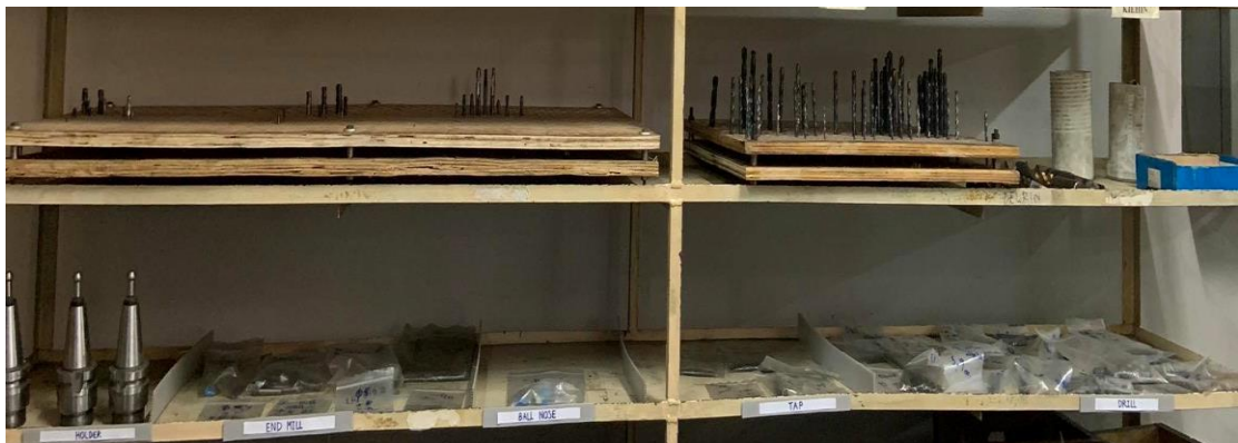
ภาพ 5.46 การแยกดอกกัดที่พร้อมใช้งานกับดอกกัดที่ต้องลับคมออกจากกัน และจัดวางแยกตามประเภทของดอกกัด
