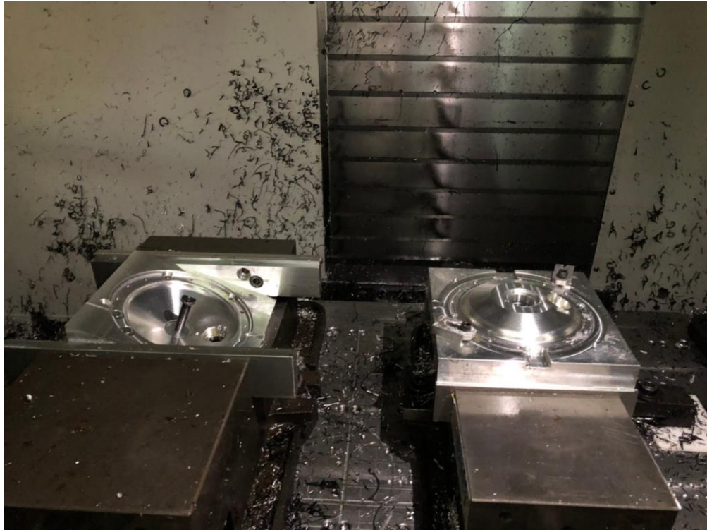
ภาพ 5.17 อุปกรณ์จับยึดชิ้นงานที่สร้างขึ้นมาเพื่อขึ้นรูปชิ้นงานทรงกลม
