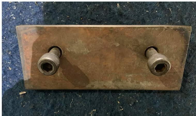
ภาพ 5.26 ลักษณะของเสียที่เกิดจากการใช้ดอกกัดผิดขนาดในการกัดชิ้นงาน
