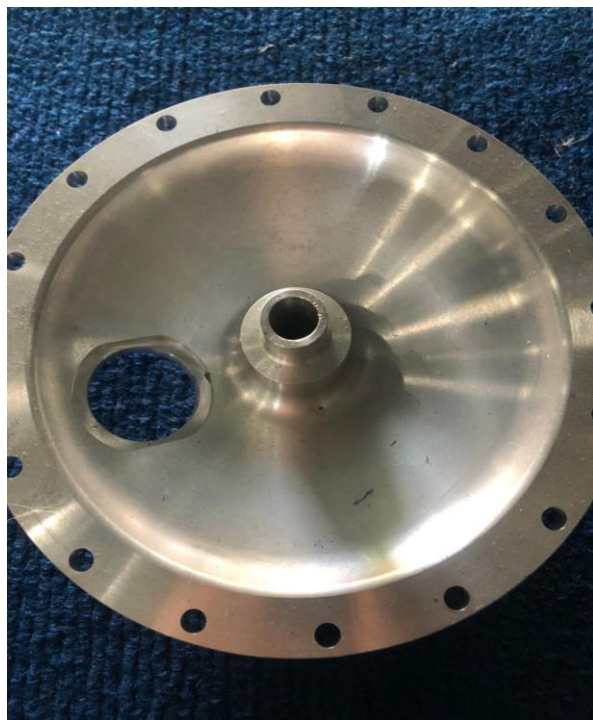
ภาพ 5.18 ชิ้นงานที่ได้จากกระบวนการหลังจากใช้อุปกรณ์จับยึดชิ้นงานช่วยในการติดตั้ง
