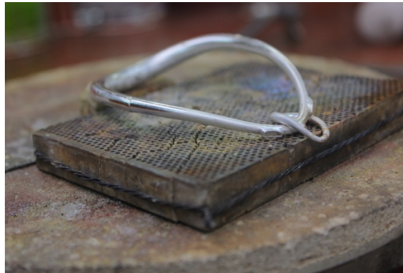
ภาพ 4.28 ชิ้นงานที่ผ่านการเชื่อมเสร็จเรียบร้อยแล้ว
