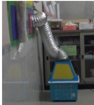
ภาพ ณ-3 เครื่อง Fresh Air Box
