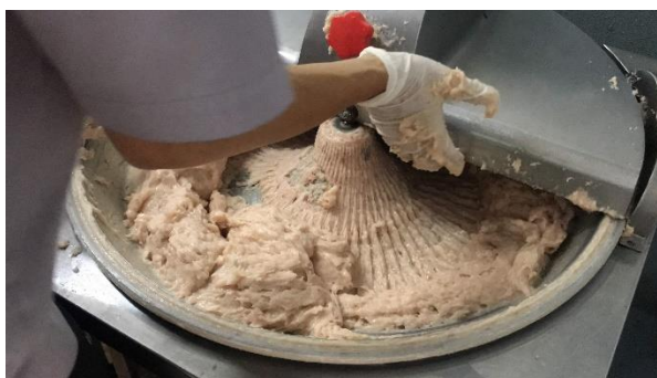
ภาพ 5.30 ขั้นตอนการสับผสม (การดำเนินกระบวนการผลิตจริง)
