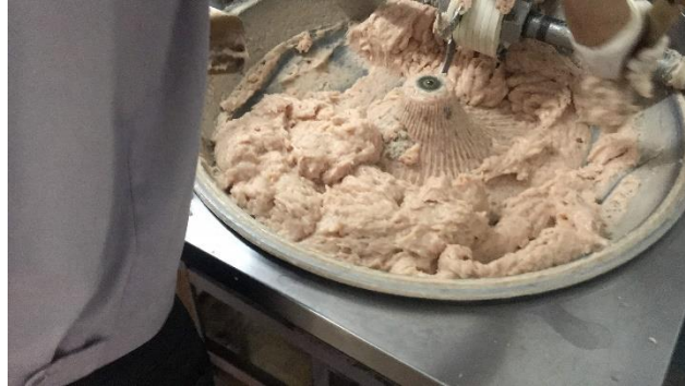
ภาพ 5.31 หยุดเครื่องสับผสม (การดำเนินการกระบวนการผลิตจริง)
