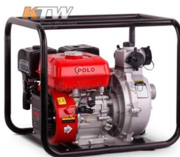
ภาพ 2.4 ภาพปั๊มน้ำเครื่องยนต์
