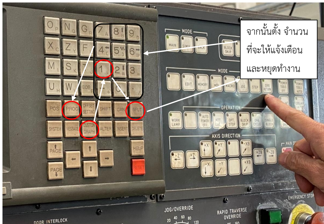
ภาพ 4.36 การตั้งค่าปริมาณการตัดชิ้นงาน
