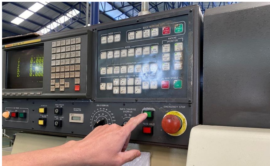
ภาพ 4.38 กดปุ่ม START เพื่อเริ่มต้นทำการผลิตชิ้นงาน
