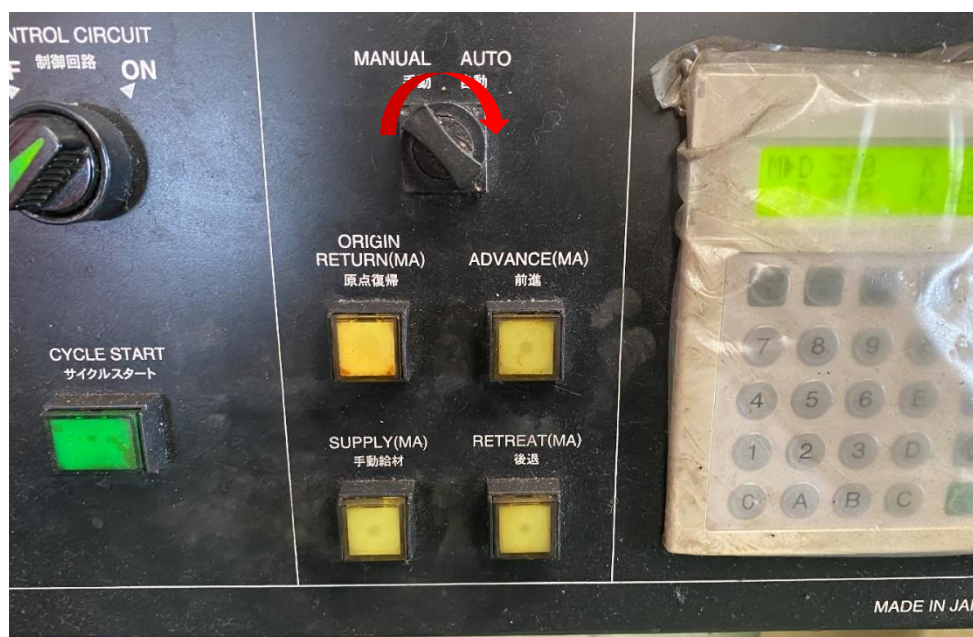
ภาพ 4.35 ปรับระบบรางเลื่อนจาก Manual ไปเป็น Auto
