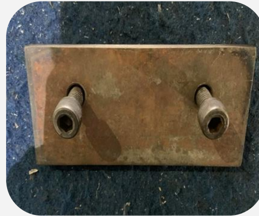
3. รูเจาะใหญ่เกินค่าที่กำหนด
