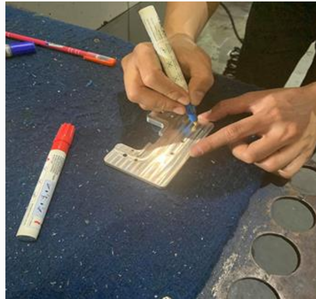
พนักงานใช้ปากกาเขียนเครื่องหมายจุดสำคัญลงบนชิ้นงาน
