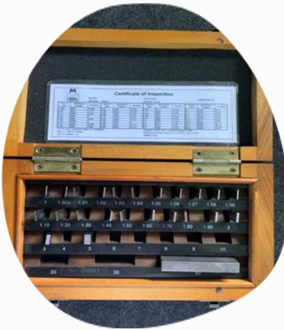
เกจบล็อกที่ใช้สอบเทียบเครื่องมือวัด
