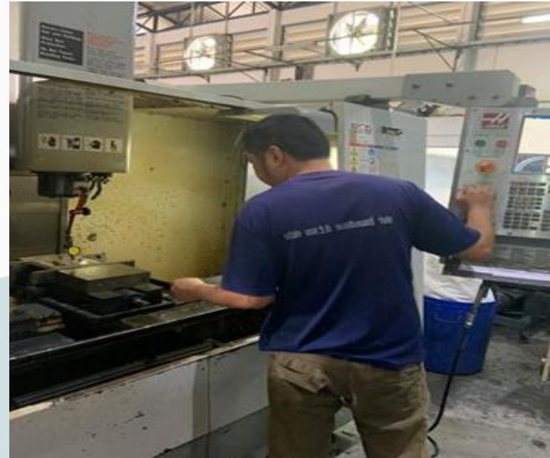
พนักงานเซต Stopper ด้วยการใช้เครื่องมือ Dial Gauge
