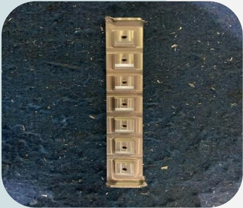
1. ระยะของชิ้นงาน ไม่ตรงตามที่แบบกำหนด
