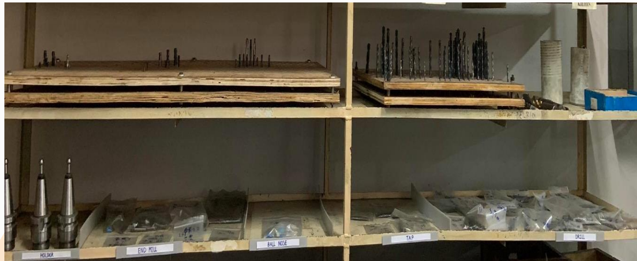
การแยกดอกกัดที่พร้อมใช้งานกับดอกกัดที่ต้องลับคมออกจากกัน และจัดวางแยกตามประเภทของดอกกัด
