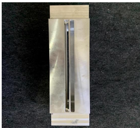
ภาพ 5.4 ของเสียในลักษณะระยะของขึ้นงานไม่ตรงตามที่แบบกำหนด
