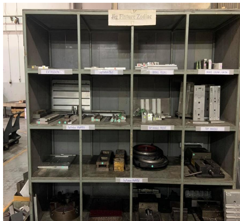
ภาพ 5.40 ชั้นวางอุปกรณ์จับยึดชิ้นงานที่มีการแยกประเภท ติดสติ๊กเกอร์ และมีป้ายระบุประเภทอย่างชัดเจน
