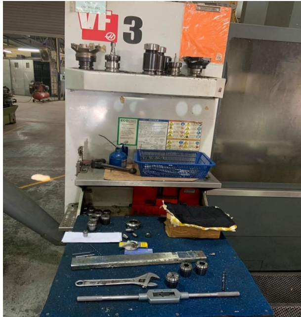
ภาพ 5.28 การจัดเก็บอุปกรณ์จับยึดดอกกัตที่กระจายไปใช้งานในแต่ละเครื่อง
