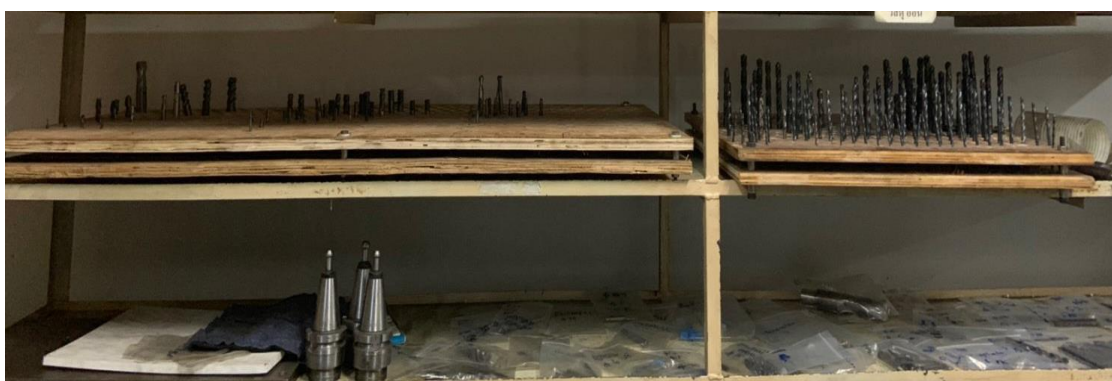
ภาพ 5.27 การจัดเก็บดอกกัดที่ไม่ได้แยกประเภทและขนาดของดอกกัดให้ชัดเจน
