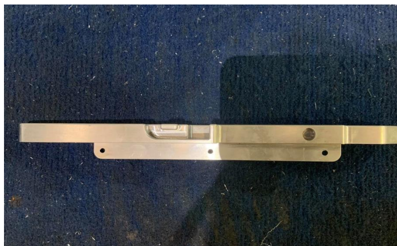
ภาพ 5.20 ลักษณะของเสียที่เกิดจากพนักงานวางชิ้นงานสลับด้าน
