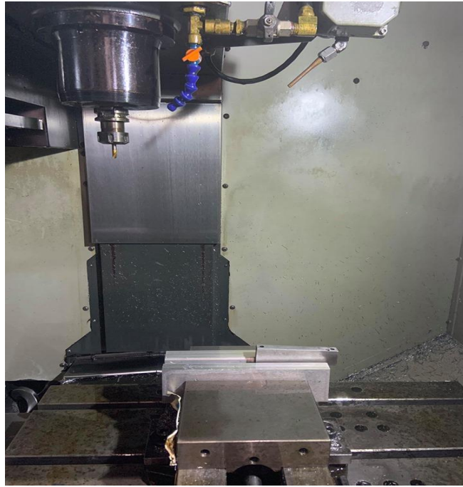
ภาพ 5.22 ลักษณะการใส่ชิ้นงานไม่แน่น ทำให้ชิ้นงานคลาดเคลื่อนไปจากตำแหน่งที่กำหนด
