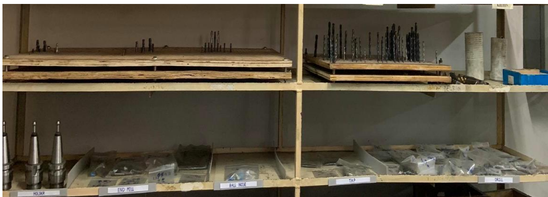
ภาพ 5.46 การแยกดอกกัดที่พร้อมใช้งานกับดอกกัดที่ต้องลับคมออกจากกัน และจัดวางแยกตามประเภทของดอกกัด
