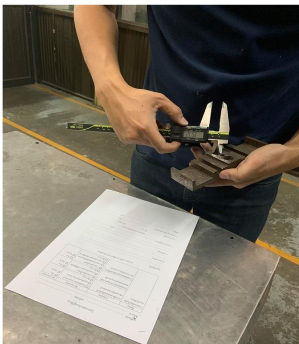
ภาพ 5.41 พนักงานตรวจเช็คเครื่องมือก่อนนำไปใช้งานด้วยเครื่องมือวัด
