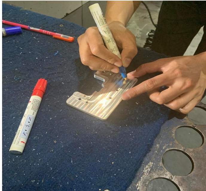
ภาพ 5.21 พนักงานใช้ปากกาเขียนเหล็กมาร์คจุดสำคัญลงบนชิ้นงาน
