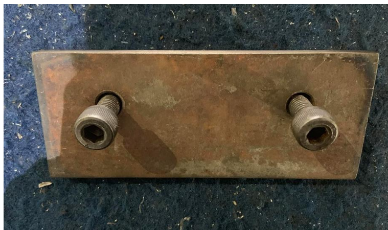
ภาพ 5.26 ลักษณะของเสียที่เกิดจากการใช้ดอกกัดผิดขนาดในการกัดชิ้นงาน
