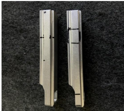
ภาพ 5.3 ของเสียในลักษณะผิวขึ้นงานมีรอยลึก
