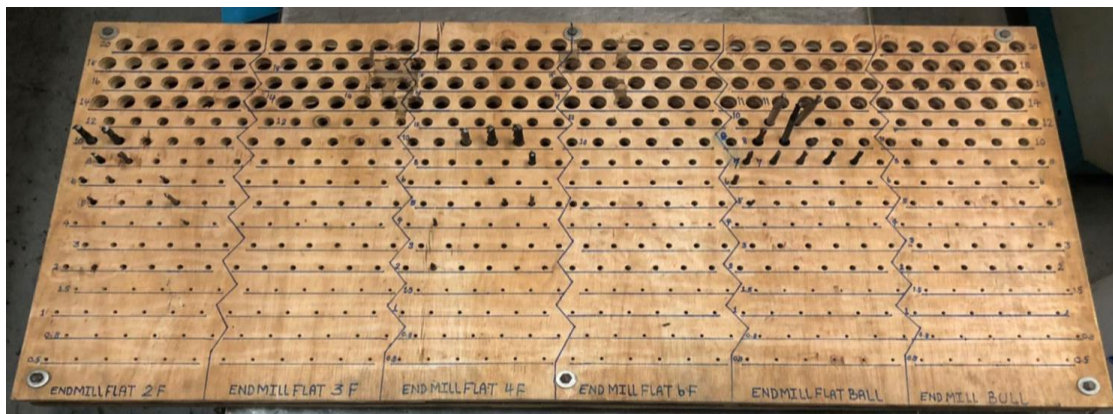
ภาพ 5.30 ที่เก็บเครื่องมือและดอกกัดที่มีการแยกประเภทและขนาดของดอกกัดอย่างชัดเจน
