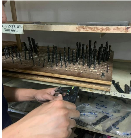
ภาพ 5.29 พนักงานตรวจเช็คขนาดของดอกกัดด้วยเวอร์เนียรก่อนนำไปใช้งาน
