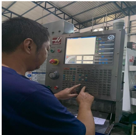
ภาพ 5.35 พนักงานตรวจเช็คตำแหน่งที่ทำการเซตศูนย์ก่อนปฏิบัติงานด้วยวิธีการตรวจเช็ค MBI
