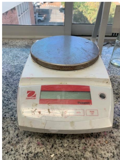
ภาพ 2.3 เครื่องชั่งน้ำหนักความละเอียด 0.01 กรัม
