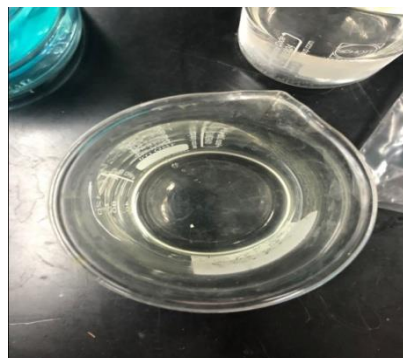
ภาพ 3.13 การละลายไคโตซานในสารละลายกรด 0.5 เปอร์เซ็นต์
