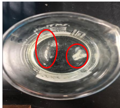
ภาพ 3.12 การละลายไคโตซานในสารละลายกรด 0.4 เปอร์เซ็นต์
