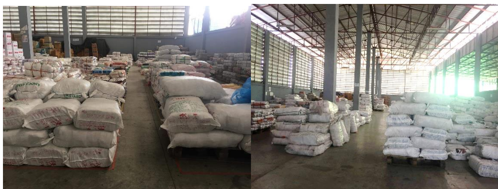
ภาพ 4.9 สภาพช่องทางเดินที่แคบ รถโฟล์คลิฟท์ไม่สามารถเข้าถึงพื้นที่ได้
