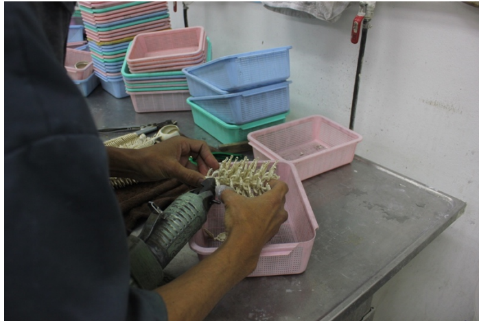
ภาพ 4.21 ขั้นตอนการตัดก้านชิ้นงาน
