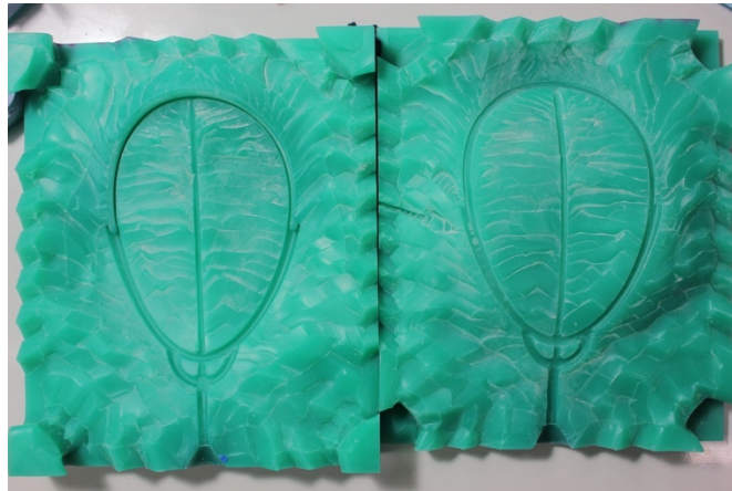
ภาพ 4.3 ต้นแบบแม่พิมพ์ยาง Link ตัวใหญ่ของผลิตภัณฑ์ Offspring Bangle
