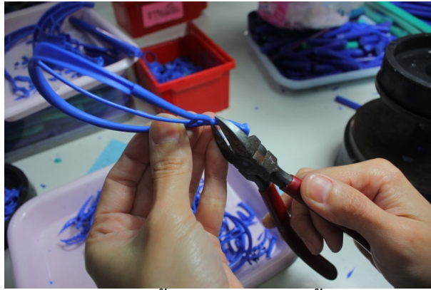
ภาพ 4.9 ขั้นตอนการตัดก้านชิ้นงาน
