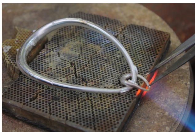
ภาพ 4.26 ขั้นตอนการประกบเชื่อม Link ตัวเล็ก
