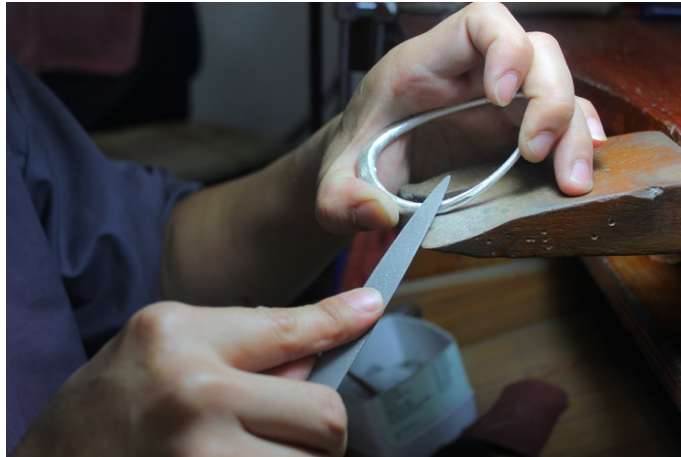
ภาพ 4.30 การขัดมือ (Hand Finishing)
