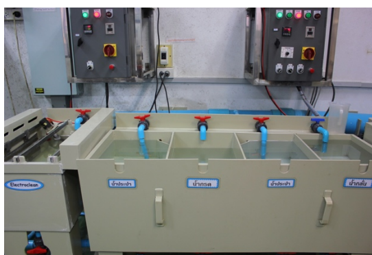
ภาพ 4.34 การล้างทำความสะอาดผิวขั้นสุดท้าย
