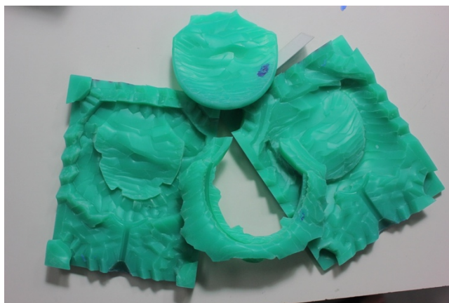
ภาพ 4.4 ต้นแบบแม่พิมพ์ยาง Link ตัวเล็กของผลิตภัณฑ์ Offspring Bangle
