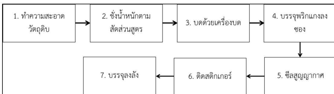
ภาพ 1.1 แผนภาพลำดับขั้นตอนการทำงานของกระบวนการผลิตพริกแกง
