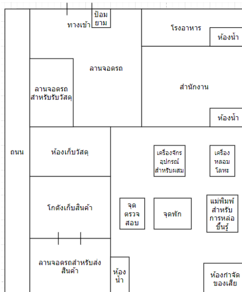
ภาพ 3.3 แสดงแผนผังโรงงาน (Plant Layout)
