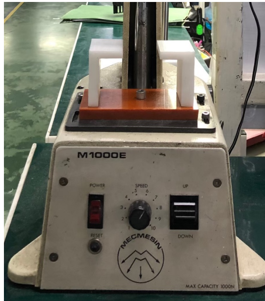
ภาพ 3.8 แผงควบคุมความเร็วและทิศทางของเครื่องทดสอบแรงดึง
