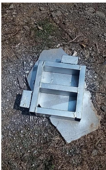
ภาพ 4.6 แม่พิมพ์อิฐขนาด 14.5 \times 7 \times 4.5 เซนติเมตร
