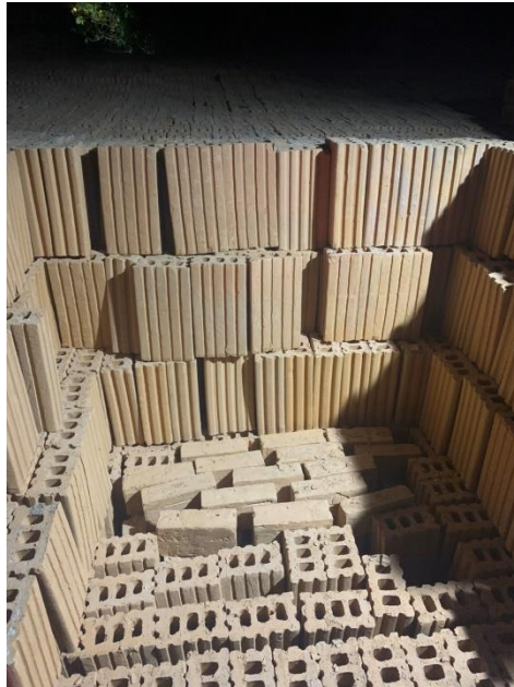
ภาพ 4.10 ขั้นตอนการเผอิฐในการทดลองเบื้องต้น
