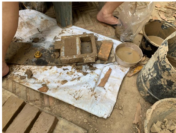
ภาพ 4.9 ขั้นตอนการพิมพ์อิฐในการทดลองเบื้องต้น
