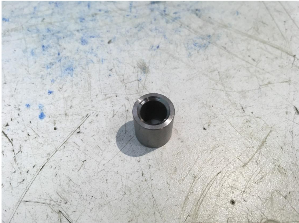
ภาพ ก-3 ลักษณะของเสียที่การลบคมปากรูตื้นเกินไป
