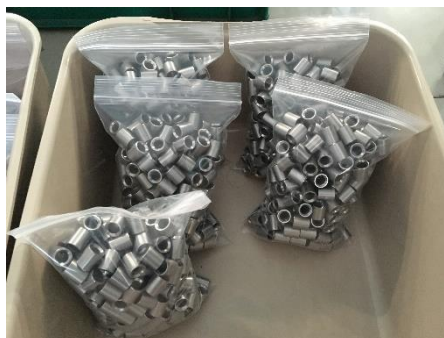
ภาพ 5.2 ชิ้นงาน 500 ตัว ที่ได้จากการปรับอัตราการป้อนเป็น 0.016 มิลลิเมตร
