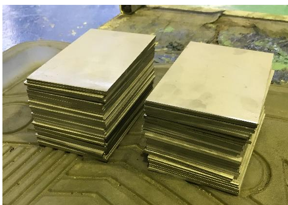
ภาพ 3.24 แผ่นเหล็กกล้าไร้สนิมขนาด 100X150X3 มิลลิเมตร
