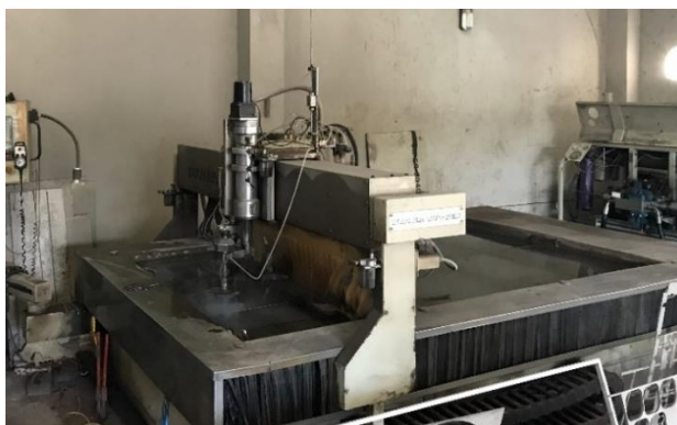
ภาพ 3.25 ตัดแผ่นเหล็กกล้าไร้สนิมด้วยเครื่อง Waterjet
