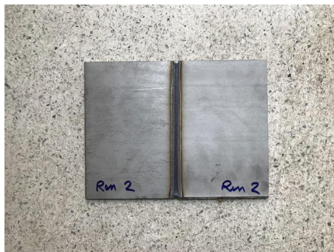
ขั้นตอนทดสอบที่เชื่อมแล้วชิ้นงานที่ 2
