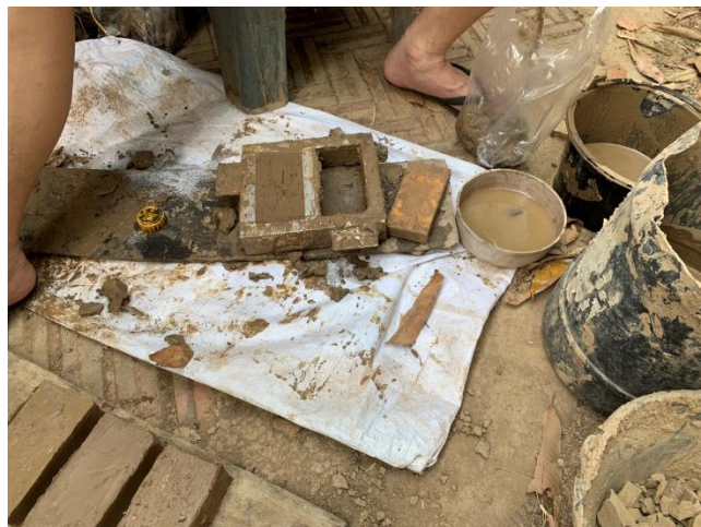
ภาพ 3.10 ขั้นตอนการพิมพ์อิฐในการทดลองเบื้องต้น
