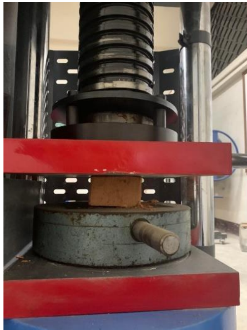
ภาพ 3.12 ทดสอบค่าความต้านแรงอัดของอิฐ
