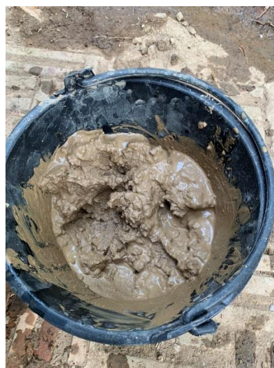
ภาพ 3.8 ขั้นตอนการผสมดินในการทดลองเบื้องต้น
