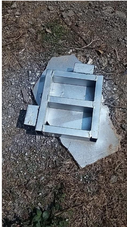
ภาพ 3.7 แม่พิมพ์อิฐขนาด 14.5x7x4.5 เซนติเมตร
