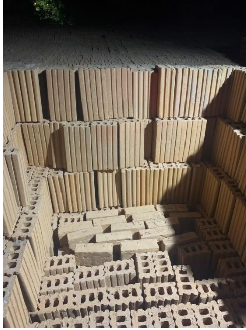
ภาพ 3.11 ขั้นตอนการเผอิฐในการทดลองเบื้องต้น
