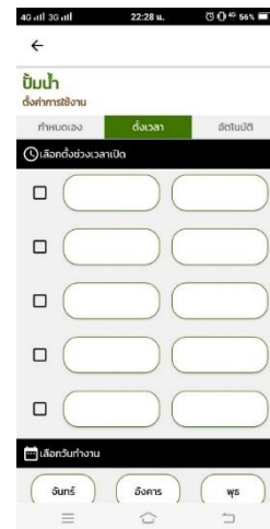
ภาพ 3.10 การสั่งเปิด ปิดปั้มน้ำด้วยการตั้งเวลา
