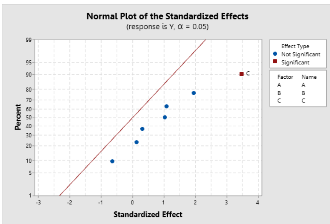
ภาพ 4.3 กราฟความน่าจะเป็นแสดงผลกระทบต่อความหนาของฟิล์มหลังการประยุกต์พลาสมา
