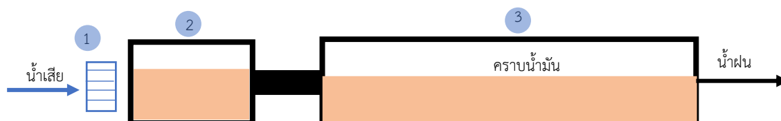
ภาพ 8.2 บ่อดักและบ่อดักไขมันสถานีบริการน้ำมันเชื้อเพลิง
