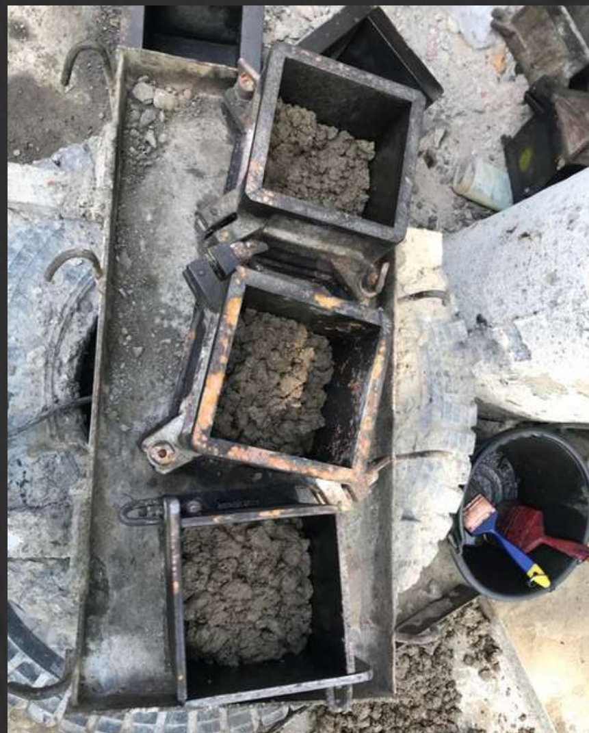
4. ใส่คอนกรีตลงในแม่พิมพ์ แม่พิมพ์ ใส่เนื้อคอนกรีตที่ลงในแม่พิมพ์ที่วางอยู่บนเครื่องเขย่าจนเต็ม
