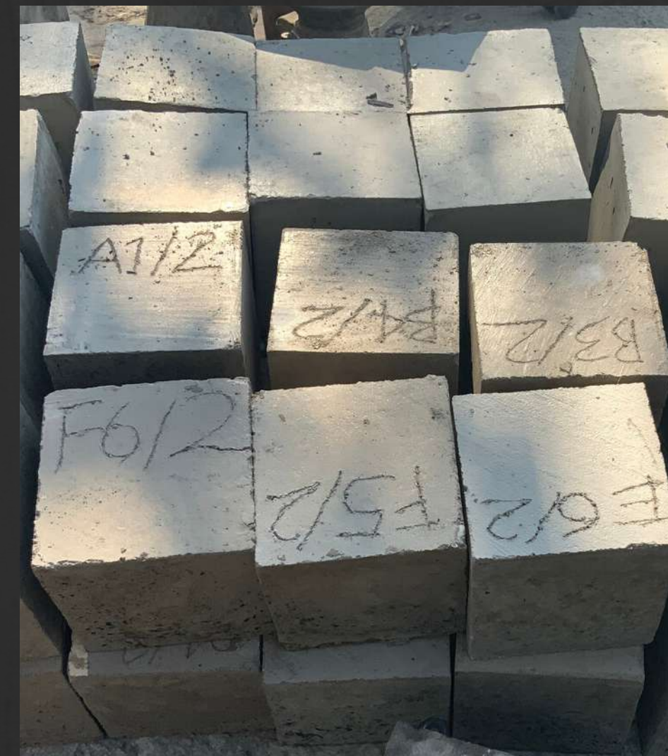
6. แคะชิ้นงานออกจากแม่พิมพ์ แม่พิมพ์ แคะชิ้นงานออกจากแม่พิมพ์เมื่อ คอนกรีตมีอายุครบ 24 ชั่วโมง
