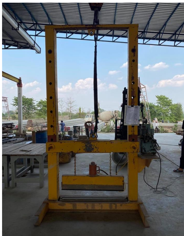
ภาพ 3.9 เครื่องทดสอบแรงอัดแตกของท่อคอนกรีต
