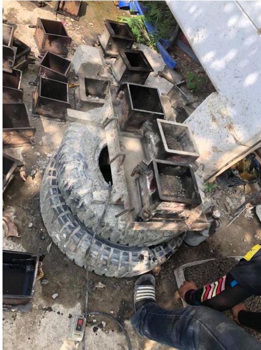
ภาพ 3.4 อุปกรณ์สำหรับขึ้นรูปแท่งคอนกรีตรูปลูกบาศก์
