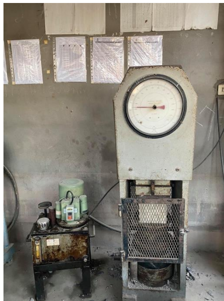
ภาพ 3.5 เครื่องทดสอบค่าต้านทานแรงอัดขนาด 1,500 กิโลนิวตัน
