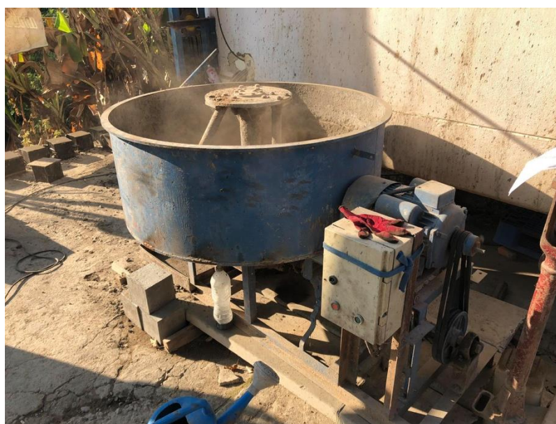
ภาพ 3.3 เครื่องโม่ปูนสำหรับผสมวัสดุดิบ
