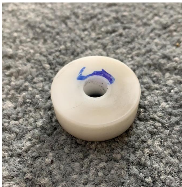
ภาพ 4.12 ฉนวนที่ทำจากซูเปอร์ลีน
