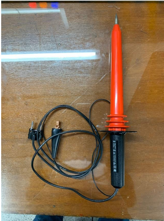
ภาพ 4.1 โพรบวัดค่าไฟฟ้าแรงดันสูงที่อัตราส่วน 1 : 1,000
