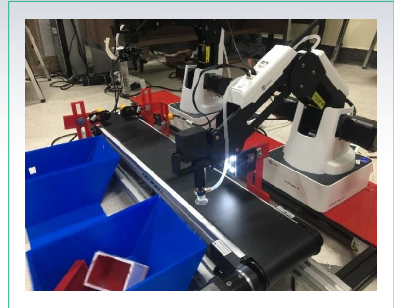
ตรวจไม่พบ DOBOT ตัวที่ 2 ทำการดันกล่อง ออกจากสายพาน
