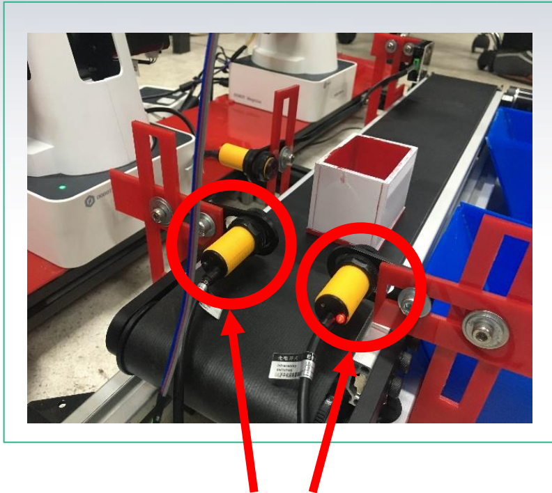
โฟโตอิเล็กทริกเซ็นเซอร์ (Photoelectric Sensor) ตรวจพบ
