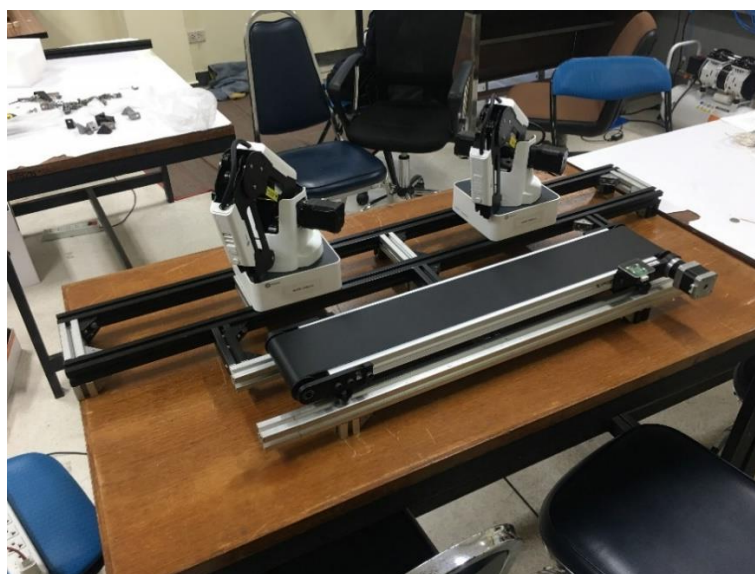
ภาพ 3.24 ประกอบอลูมิเนียมโปรไฟล์เมื่อเสร็จ
