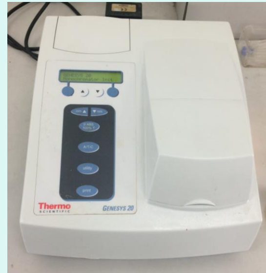
ใช้ปรับความเข้มข้นของแบคทีเรีย เครื่อง UV-Vis spectrophotometer
